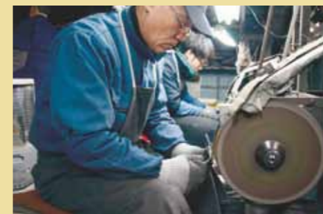
プレス加工された部品を、角度を変えながらバフ研磨していく。材質やサイズの異なるバフや、粗さの異なる研磨材を使い分ける。
